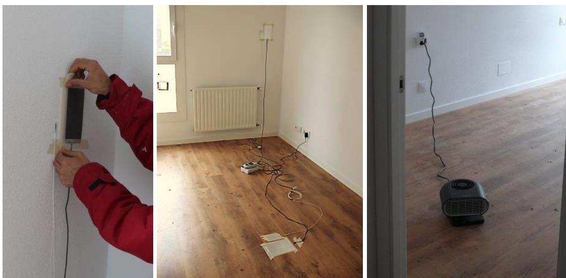
Figura 4 – Puesta en sitio del medidor de flujo de calor y de temperatura interior tanto en fachada como en forjado sobre portales en la vivienda de la planta primera, y conexión del calefactor a través de un programador de encendido.
