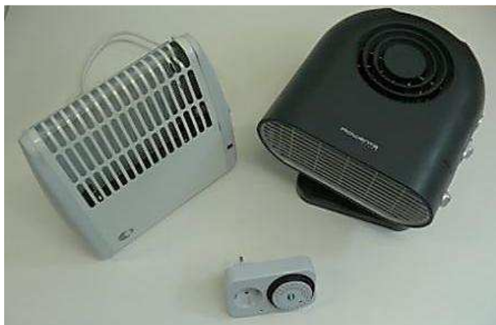
Figura 3 – Calefactores de 400 W (izquierda) y 1200 W (derecha) empleados para la excitación térmica del interior de las viviendas, activados mediante conectores programables (centro).
