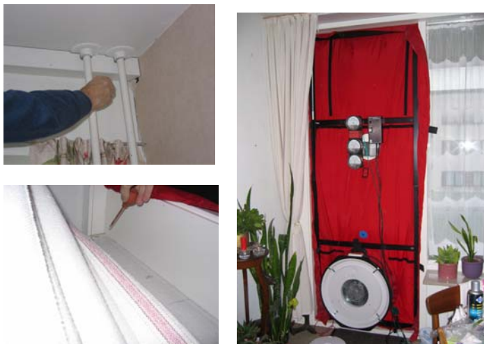
Fig.3.2.1.1. Blowerdoor test in Gyldenrisparken
