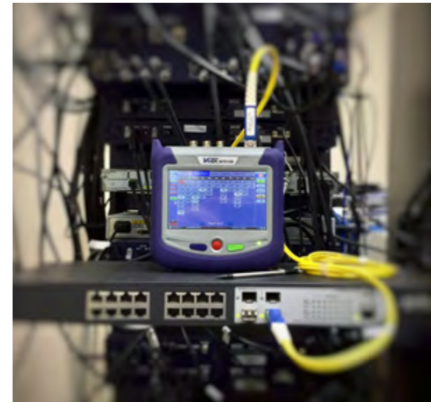
Ensemble de test de télécommunication connecté à un commutateur réseau, pour effectuer des mesures de qualité de transmission de données. ©Polo Ildefonso, Unsplash
