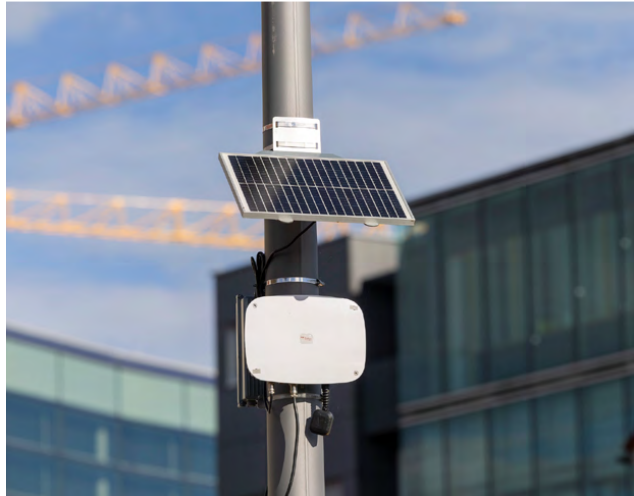
Das Projekt IMAGINEXT, das vom EIT Urban Mobility mitfinanziert wird, pilotiert eine KI-gesteuerte Software-as-a-Service-Lösung zur Messung der Luftqualität in Lindau, Deutschland. In Lindau installierte Sensoren bewerten Veränderungen der Luftqualität vor und nach dem Umbau von Radverkehrsstraßen. ©EIT Urban Mobility
