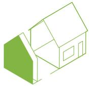
Bei der Fassade kann die Dämmschicht außen, innen oder im Hohlraum der Wand angebracht werden.
