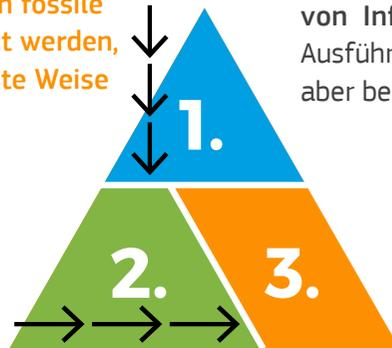
Mit dem Konzept der **Trias Energetica** im Hinterkopf sollte die Realisierung eines energieeffizienten Gebäudes immer **mit der Reduzierung der Wärme- (oder Kälte-) Verluste** aus dem klimatisierten Innenraum nach außen **beginnen**.
